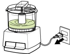
2 容器からふたをはずし、本体から容器を外します。ヘラを使って材料を取り出します。
